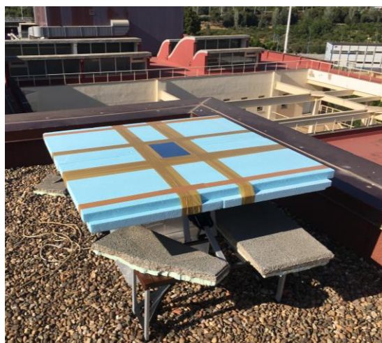
Ilustración 27. Experimento 2. Chapa aislada sobre superficie real
