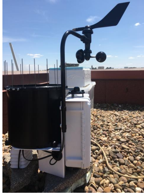
Ilustración 14. Estación meteorológica WatchDog con el experimento al fondo
