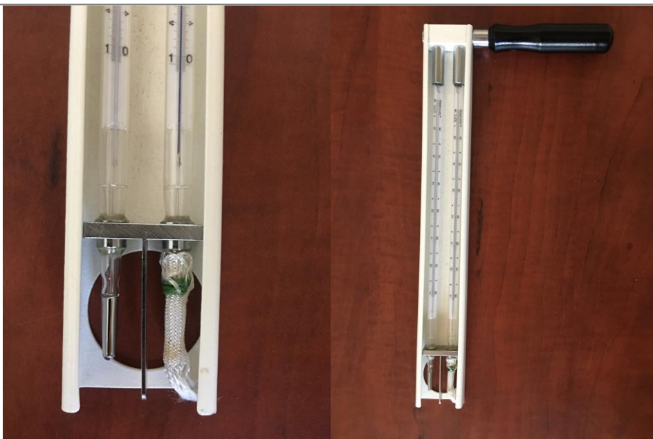
Ilustración 74. Termómetro de carraca. Extremos para medir temperatura de aire y temperatura de bulbo húmedo (izquierda) y termómetro completo (derecha)
