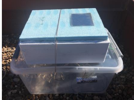
Ilustración 63. Experimento 1. Chapa aislada confinada
