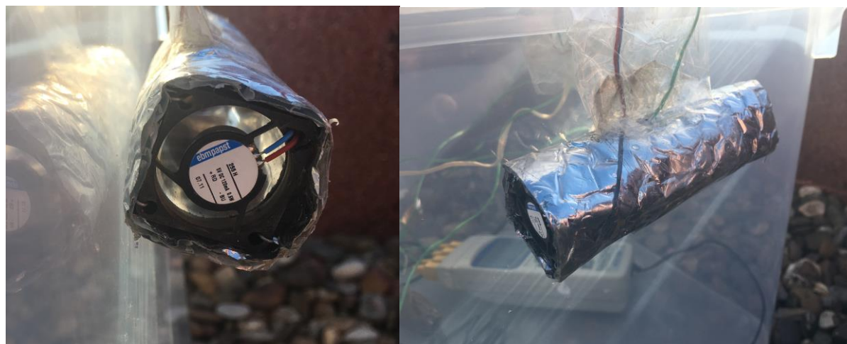
Ilustración 12. Sensor de temperatura exterior en tubo aislado con extracción de aire
