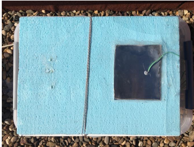
Ilustración 17. Modificación con el termopar K4 en la superficie exterior de la chapa
