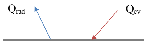
Ilustración 5. Intercambios de calor en la superficie de la chapa.
