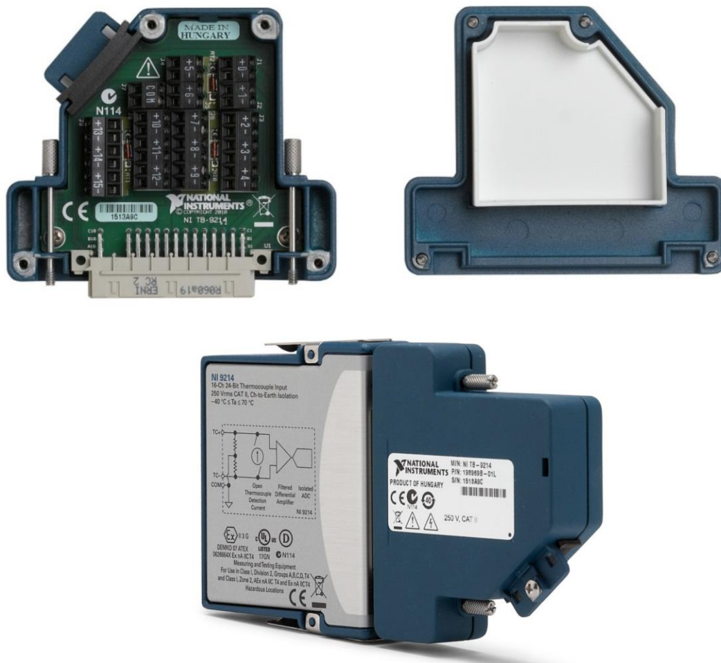
Ilustración 79. Interior y exterior del NI TB-9214
